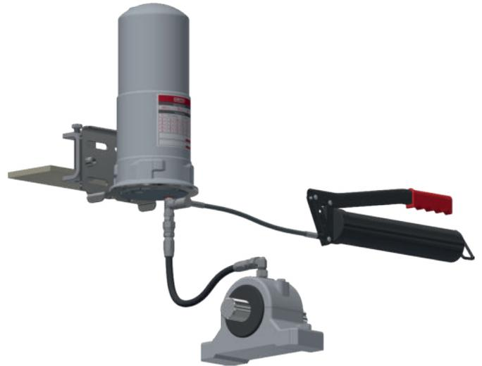
5. Bei Montage mit einem MONTAGE SET oder einem ANSCHLUSSTEILE SET Standard Duty verwenden Sie zum Vorschmieren und Befüllen der Schlauchleitungen einen Schlauchvorfülladapter: SET SCHLAUCHVORFÜLLADAPTER (117907)
